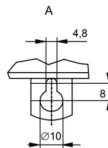
Разметка для крепления прибора
