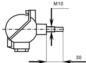
Рис. 6.2. Датчик измерения температуры наружного воздуха (тип ТДВ).
