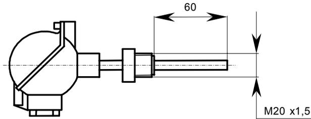
Рис. 6.1. Датчик измерения температуры теплоносителя (тип ТДТ).
