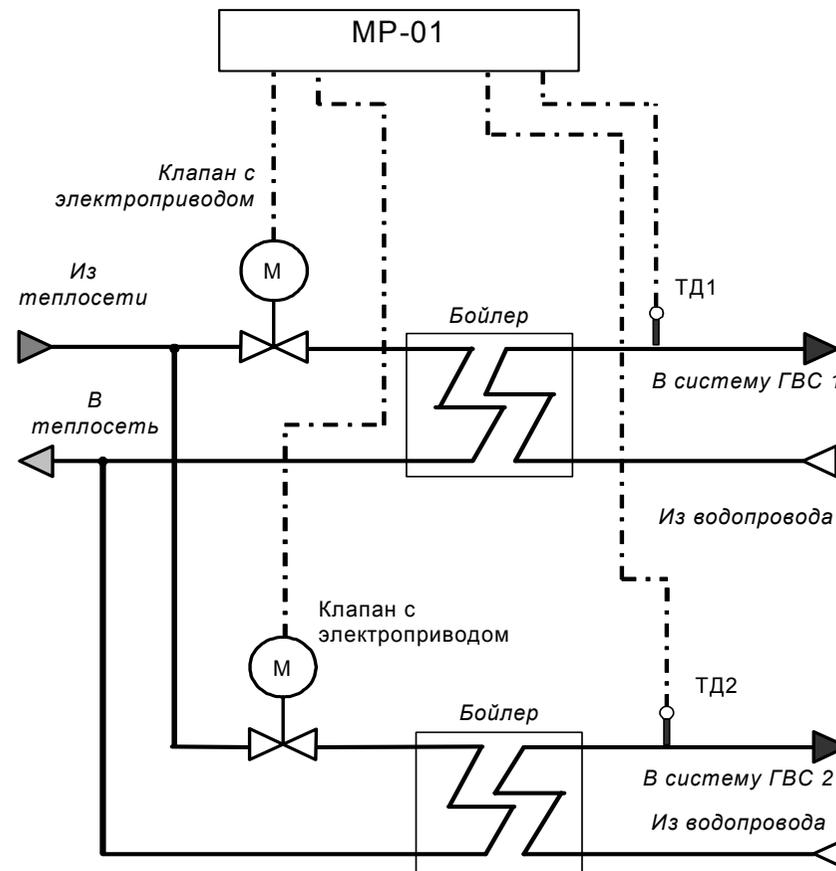
*Пример применения.* Устройство поддерживает температуру горячей воды на выходе из бойлера в дневное время, например 55 °С, в ночное время, например 30 °С. Каждый контур настраивается независимо от другого.
