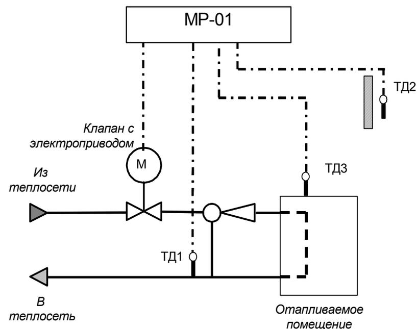
*Пример применения.* Устройство поддерживает заданный температурный график обратной воды в зависимости от температуры наружного воздуха. Возможно задание нормального и (или) пониженного режимов в различных вариантах.
