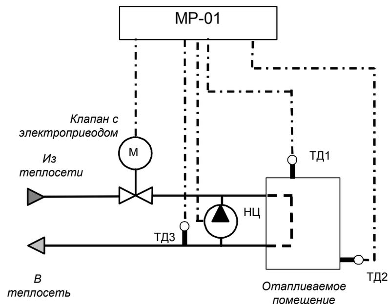
*Пример применения.* Устройство поддерживает в рабочее время в помещении комфортную (нормальную) температуру (например, 18 °С), а в нерабочее время – пониженную температуру (например, 10 °С). Возможно управление насосом (НЦ), установленным на подмесе обратной воды.
