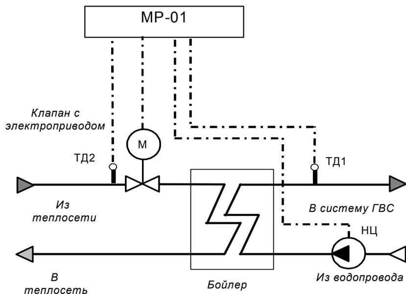
*Пример применения.* Устройство поддерживает температуру горячей воды на выходе из бойлера в дневное время, например 55 °С, в ночное время, например 30 °С. Для обеспечения нормальной циркуляции возможно использование циркуляционного насоса (НЦ). В случае снижения температуры подаваемого теплоносителя ниже задаваемого значения (tзо), поддерживаемая температура горячей воды на выходе из бойлера снижается на величину разности между tзо и топ.
