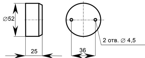
Рис. 6.3. Датчик измерения температуры в помещении (тип ТДП).
