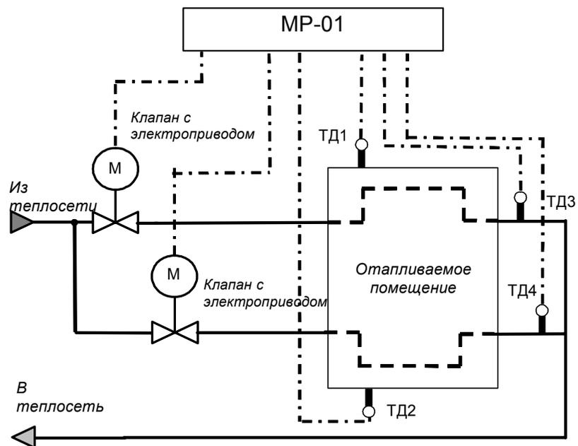
*Пример применения.* Устройство поддерживает в рабочее время в помещениях комфортную (нормальную) температуру (например, 18 °С), а в нерабочее время – пониженную температуру (например, 10 °С). Все параметры управления задаются автономно для каждого контура.
