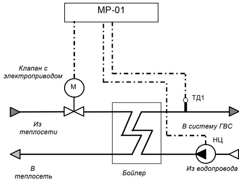
*Пример применения.* Устройство поддерживает температуру горячей воды на выходе из бойлера в дневное время, например 50 °С, в ночное время, например 30 °С. Для обеспечения нормальной циркуляции возможно использование циркуляционного насоса (НЦ).
