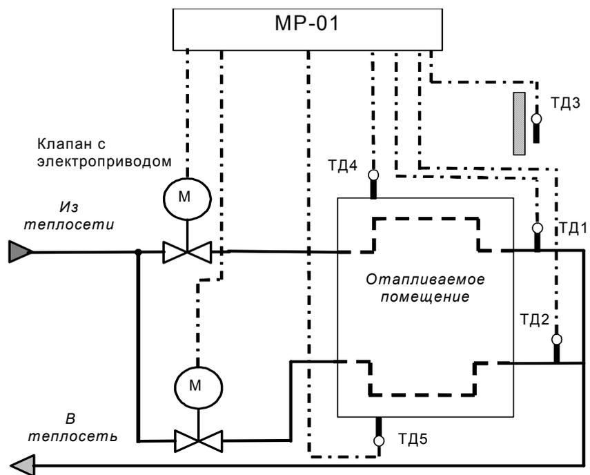
*Пример применения.* Устройство поддерживает заданный температурный график обратной воды по двум независимым контурам регулирования в зависимости от температуры наружного воздуха. Возможно задание нормального и (или) пониженного режимов в различных вариантах.
