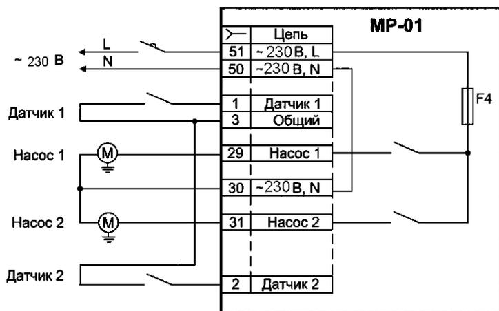
Рис. 4.2 Схема подключения к МР-01 насосов с управлением по датчикам давления в режимах «ДВ» и «ДВР». В режиме «ДВР» защита от отсутствия теплоносителя производится с помощью Датчика 1 и Датчика 2 соответственно для работы Насоса 1 и Насоса 2.
